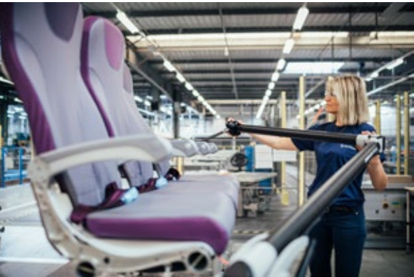
Contrôle qualité dimensionnel grâce au bras de mesure Romer sur la ligne d'assemblage finale, Cyril Abad / CAPA Pictures / Safran
