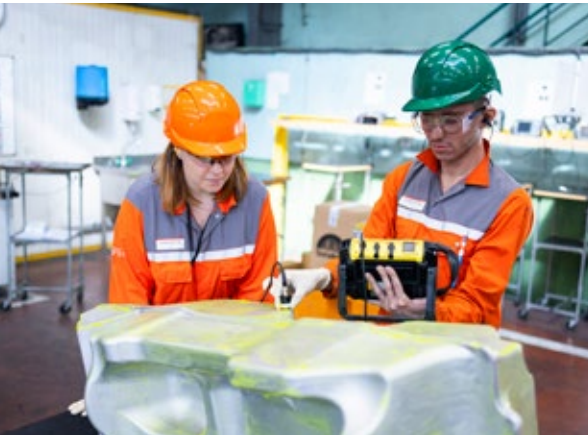
Contrôleur CND niveau 1 formant une contrôleuse nouvellement arrivée sur une pièce aéro © Aubert & Duval/C.ABAD
